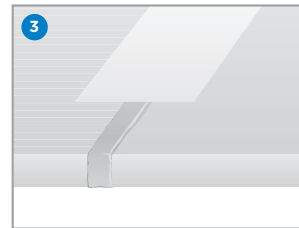
Fugenbild mit Rigidur in Spachtelfugentechnik mit 5 mm Fugenspalt und Verarbeitung mit Rigips VARIO Rigidur Fugenspachtel.
