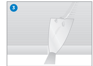
Fugenbild mit Rigidur in Klebefugentechnik auf Stoß stumpf verlegt und mit Rigidur Nature Line Fugenkleber verklebt - Über-spachtelung der Fuge und Befestigungsmittel mit Rigips VARIO Rigidur Fugenspachtel.
