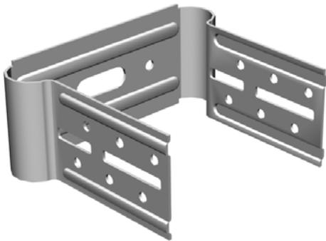
Rigips Justierschwingbügel CD 60 dienen zur rückwärtigen Befestigung Rigips CD 60/27 Profilen in Vorsatzschalen und Wandbekleidungen. Die Öffnungsweite des Bügels von 60 mm ist auf das Rigips CD-Profil abgestimmt. Die seitlichen Schenkel verfügen über Rund- und Langlöcher, um das CD-Profil zu befestigen. Die Verankerung des Rigips Justierschwingbügel erfolgt über die Öffnungen in der Basis des Bügels. Die Biegung des Bügels erfolgt bauseitig.
