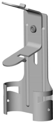
Rigips Schnellabhänger für CD 400 dienen zur Ausbildung von Abhängungen in Gipsplattensystemen im Deckenbereich. Die Abhängung erfolgt mit Rigips Ösen- oder Hakendrähten durch seitliche Einführung in die angenietete Feder. Der Schnellabhänger für CD 400 ist damit justierbar und ermöglicht die Aufnahme des Rigips C-Deckenprofils als Grundprofil der Deckenkonstruktion. Die Montage erfolgt durch seitliches Eindrehen in das Rigips C-Deckenprofil.
